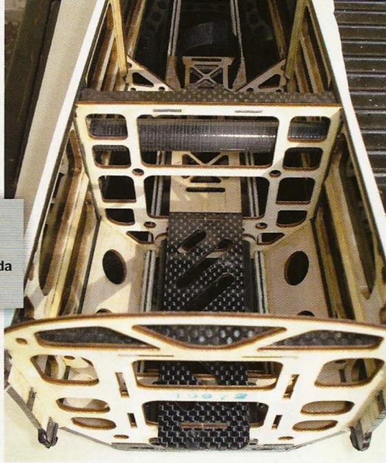
Vista frontal superior de la estructura mixta empleada en el modelo.
