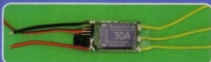
le contrôleur proposé par FUN Model pour la propulsion du Katana mini est un Hyperion supportant des packs Li-Po 2S et 3S, pour des courants de 30A.
