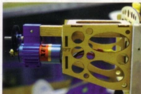
Le moteur HIMAX réduit impose d'utiliser une fixation par tasseau. Fort heureusement, cela est prévu dans le kit du Katana mini, et ne pose donc aucun souci !
