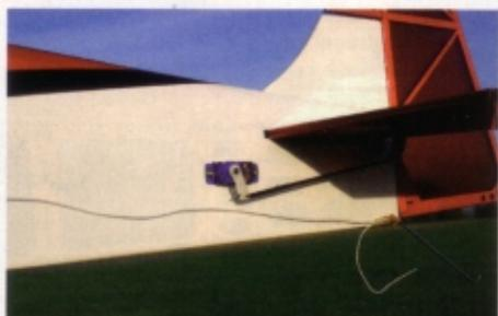
Détail du servomoteur pilotant les volets mobiles de la profondeur.
