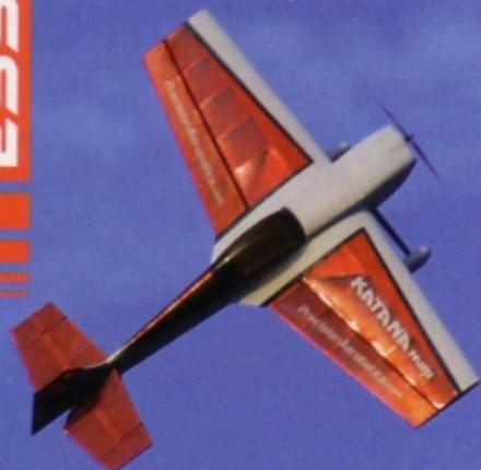
blées avec plusieurs renforts en carbone, permettant d'obtenir une machine très légère, fine et délicate comme de la dentelle. L'aile est fournie en deux panneaux également entoilés, tout comme la profondeur et la dérive. Cela correspond donc réellement à un kit « ARTF ».
