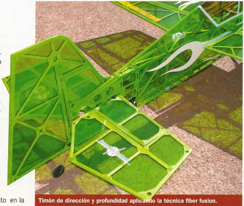
Timón de dirección y profundidad aplicando la técnica fiber fusion.
