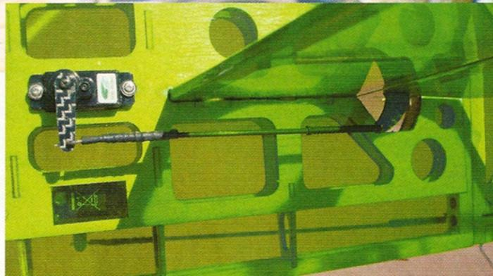
Transmisión de carbono en profundidad de sencilla instalación.
