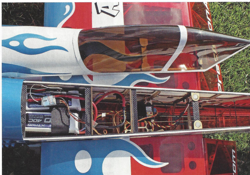
Die Fiber-Fusion-Bauweise ist sehenswert – die CFK-Verstärkungen vermitteln einen hochwertigen und edlen Charakter.
