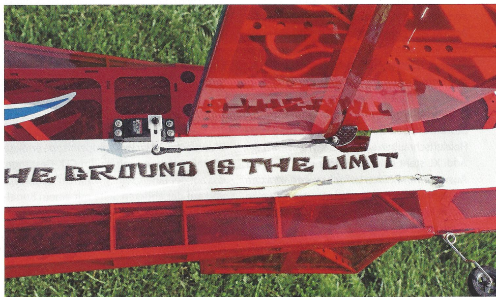
Das Höhenruderservo sitzt im Heck – die Ruder-Anlenkung erfolgt beidseitig mit Kugelköpfen.
