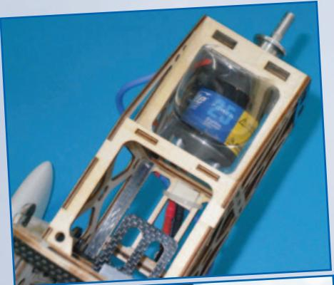
Il motore è raffreddato tramite due veri condotti in plastica trasparente che deviano il flusso esattamente sulla cassa rotante
