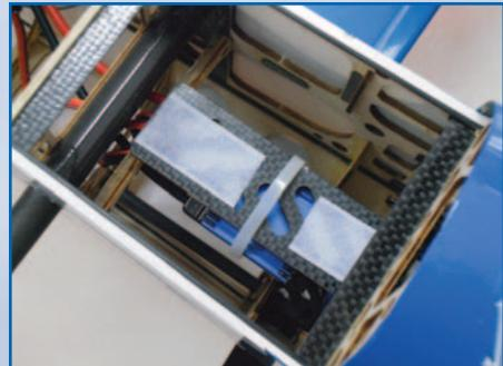
La piastra porta batteria è ottima anche per fissare il regolatore
