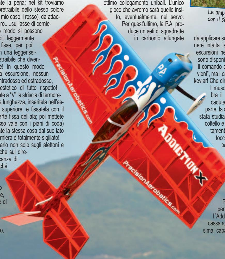
con un'elica 14x7 ed un pacco LiPo 3S da 2200-2800 mAh con 30C di capacità di scarica, e regolatori da 40A.
