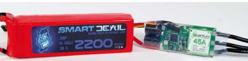
Mit dem 2.200-Milliamperestunden-3s-LiPo sind 3D-Flugzeiten von etwa zehn Minuten realisierbar. Zu verdanken ist diese Effizienz unter anderem dem Regler, der bestens auf den Motor abgestimmt ist. Beide Komponenten sind bei Braeckman erhältlich
