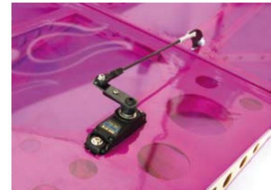
Ein CFK-Stab, ein Alu-Gabelkopf am Ruder sowie ein Kunststoff-Kugelhkopf am Servo und ein CFK-Servohebel als Verlängerung bilden eine spielfreie und solide Anlenkung
