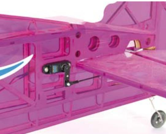
Insgesamt vier Blue Bird Corless Digital-Servos vom Typ BMS-390DMH setzen die Steuerbefehle des Piloten um
