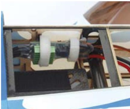
*Der Quantum-Regler wurde beim Testmodell mit zwei Klettchlaufen auf einem kleinen Brettchen an der rechten Rumpfsseitenwand neben dem Akku befestigt*
