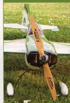
»Katana MD« mit eingebauten Antriebskomponenten. Leichte Precision-Aerobatics-Carbon-Spinner mit Alu-Rückplatte und hochpräzise ausgewuchteter VOX-Holz-Luftschraube
