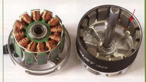
Thrust20-Motor: Statorwicklung mit Garn gesichert (links), die Glocke ist mit Ausgleichsmasse ausgewuchtet (rechts)
