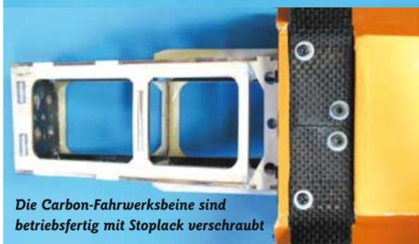
Die Carbon-Fahrwerksbeine sind betriebsfertig mit Stoplack verschraubt
