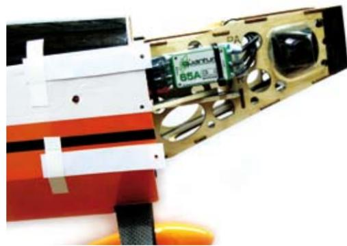
**Nach dem Vorbohren der Schraubenlöcher für die Motorhaubenbefestigung werden die Löcher zielgenau mit angeklebten Papierstreifen markiert**
