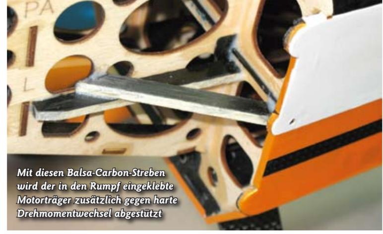
Mit diesen Balsa-Carbon-Streben wird der in den Rumpf eingeklebte Motorträger zusätzlich gegen harte Drehmomentwechsel abgestützt
