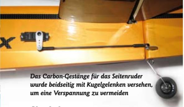
Das Carbon-Gestänge für das Seitenruder wurde beidseitig mit Kugelgelenken versehen, um eine Verspannung zu vermeiden
