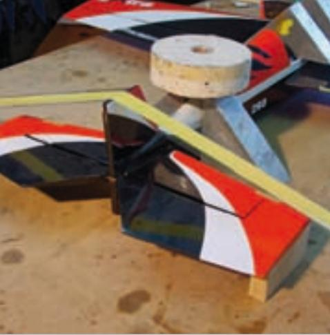
Beim Einkleben des Höhenleitwerks wird die zunächst schräge Seitenleitwerksflosse mit Klebeband wieder senkrecht gezogen.
