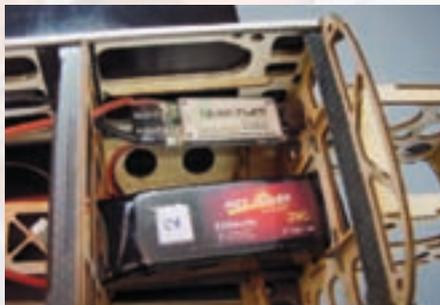
LiPo Jack Power und Stellerposition für die hintere 3D-Schwerpunktlage. Der Akku ist leicht und kommt gut mit Stromspitzen zurecht.
