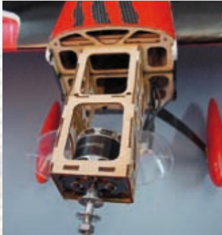
Eingebauter Motor PA Thrust 30 mit Lufthutzen. Der Motor bietet ein gutes Leistungs-Gewichts-Verhältnis.
