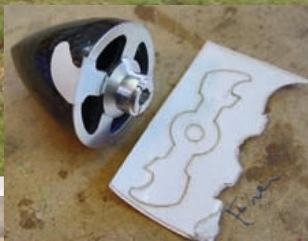
Mit aufgeklebter Schablone wird der Spinnerausschnitt bestimmt.
