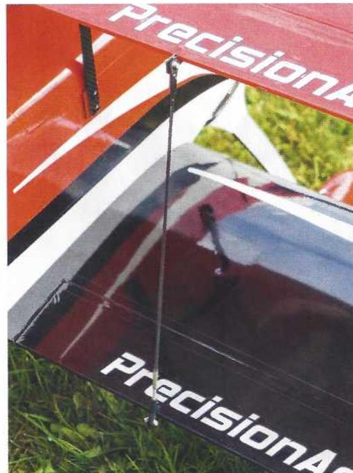
Pro Flächenseite ist ein Servo eingesetzt. Die Anlenkung zur oberen Tragfläche erfolgt über Schubstangen
