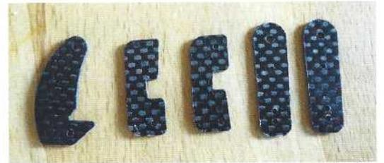
Die Kleinteile bestehen aus hochwertigen Materialien, hier CNC-gefrästes CFK
